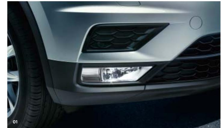
**01** Die Nebelscheinwerfer mit statischem Abbiegelicht leuchten den Abbiegebereich aus. Bei eingeschlagenem Lenkrad oder gesetztem Blinker wird das Licht situationsabhängig an Kreuzungen oder Einmündungen unterhalb von 40 km/h automatisch zugeschaltet. **C H SO**
